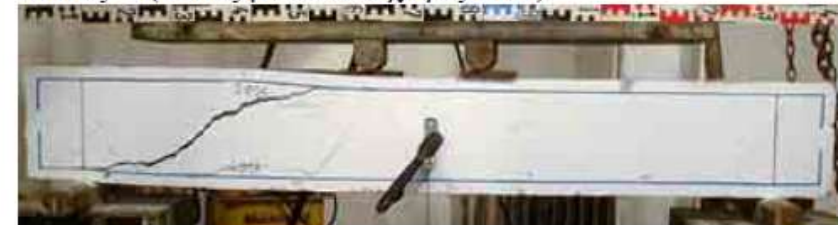
Δοκός R (ορθογωνική δοκός χωρίς FRP)
