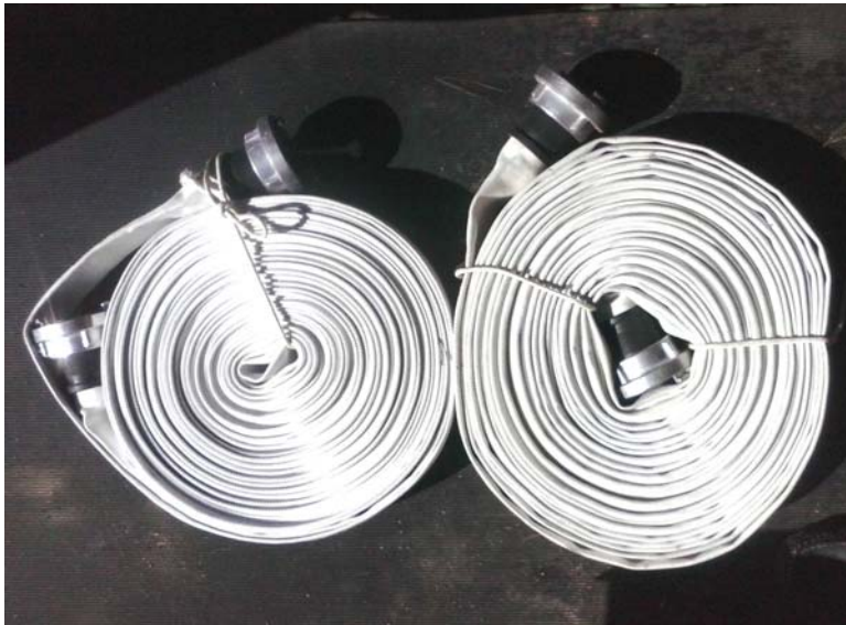
Εικόνα 14. Τρόποι τυλίγματος των κανάβινων σωλήνων.
