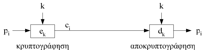
Σχήμα 5.1 Τρόπος λειτουργίας ECB
